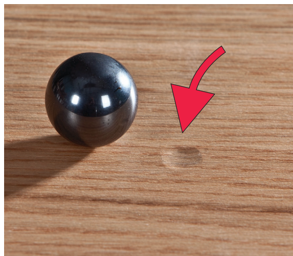
Deska dębowa warstwowa (36,5 N/mm 2 )
